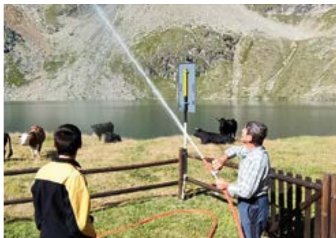
Prove tecniche per la lancia antincendio.
